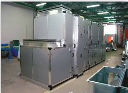
Центральный кондиционер с роторным регенератором
